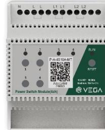
4 路開關執行器具有繼電器通斷和繼電器狀態指示功能。主設備(M)採用電力線載波通信與網關交互，採用RS485與接入從設備通信，每台主設備可管理3台從設備。從設備(S)採用RS485與主設備通信。主從設備均可實現對負載迴路的控制，主要應用在智慧建築的照明系統中，完成照明白智化。
